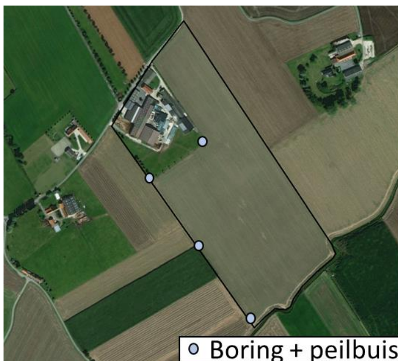
Figuur 4.19. Locaties van boringen en peilbuizen.
