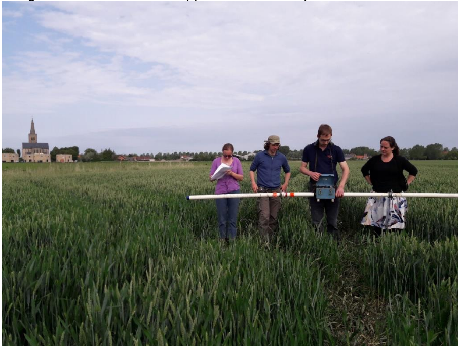
Figuur 4.9. Het uitvoeren van EM31 metingen op het perceel van bedrijf 1. Dit apparaat is een kleine versie van de meetapparatuur die is gebruikt bij de helikoptermetingen.
