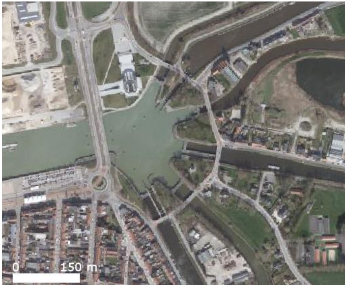
Figuur 2.15. Luchtfoto van het Ganzepootcomplex te Nieuwpoort. Beginnend in het noorden en in wijzerzin worden aangetroffen: het Nieuwbedelf, het kanaal Plassendale-Nieuwpoort, de Oude IJzer, de gekanaliseerde IJzer, de Noordvaart en het kanaal Duinkerke-Veurne. Het is een cruciaal punt voor de afwatering van het westelijk kustgebied. Vervaardigd o.b.v. gegevens http://www.geopunt.be .
